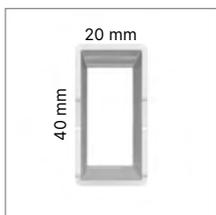
Traverses, longerons réalisés en tube décapé à section rectangulaire 40×20 mm, ép. 1,5 mm. Fixés aux plans et au système d'élévation par des vis à filetage métrique.
