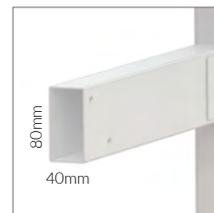
Traverse de liaison entre les colonnes d'élévation en tube profilé décapé, section 80x40 ép. 1,5; fixée aux colonnes par de vis à filetage métrique.
