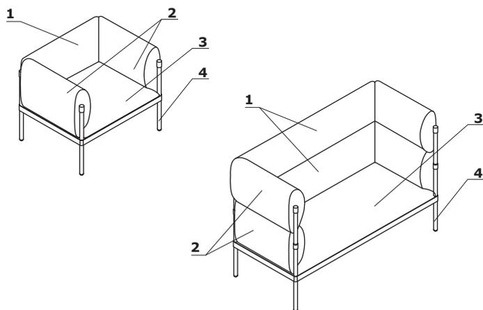
1. **Dossier** - structure en panneaux de particules de 18 mm d'ép.; mousse découpée, mousse injectée d'une densité de 25 kg/m<sup>3</sup>; tapissée
