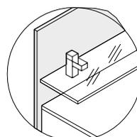
Fabriqué en panneau de 18 mm d'épaisseur. Permet de suspendre une tablette en verre.
