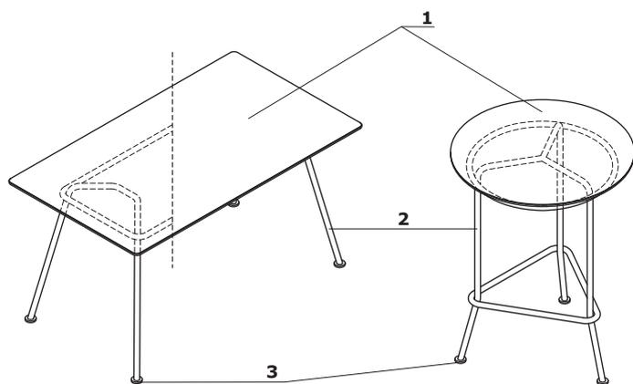
1. **Plateau** – panneau MDF 19 mm ; finition linoléum bactériostatique anti-traces de doigts
